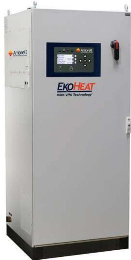
機能に優れるEKOHEATパワーコントロールシステムにより、高速自動周波数チューニング、加熱効率が高く精密な加熱、分解能0.2%の出力コントロール、使いやすく読みやすいフロントパネルが実現されています。リモートコントロールは、0-10Vまたは4-20mAアナログ入力、RS485シリアルポート、24V コントロール、リモート緊急停止入力を用意されており自動機器による製造ラインへの導入も容易です。
